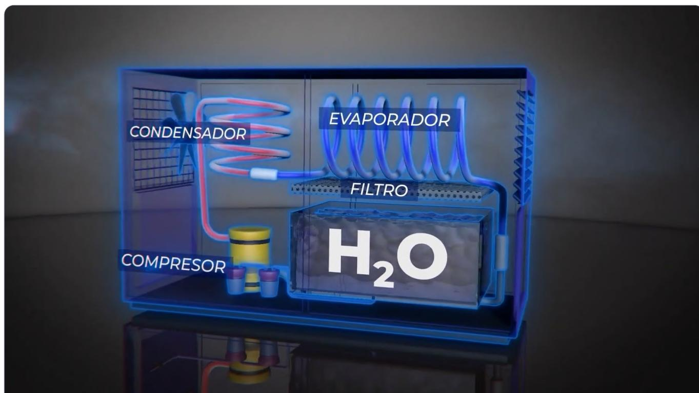
**Figura 124:** La imagen muestra una representación esquemática de un generador de agua atmosférica, ilustrando sus partes constituyentes y el principio de funcionamiento.
