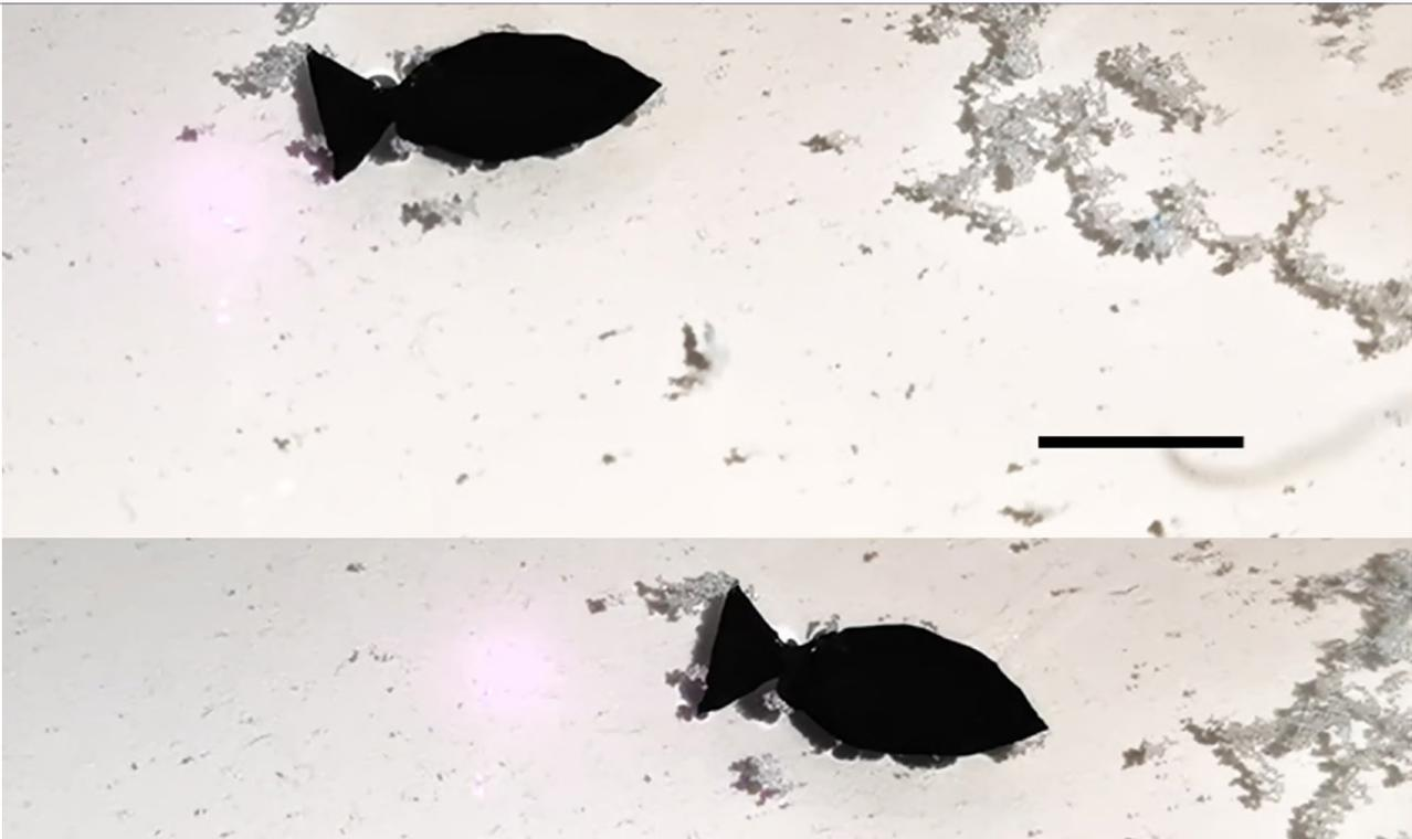
**Figura 123:** La imagen muestra un pequeño pez robot desarrollado por investigadores de la Universidad de Sichuan. Este dispositivo compacto, parecido a un pez real, nada en el ambiente acuático y adsorbe activamente los fragmentos de microplásticos presentes en el agua.
